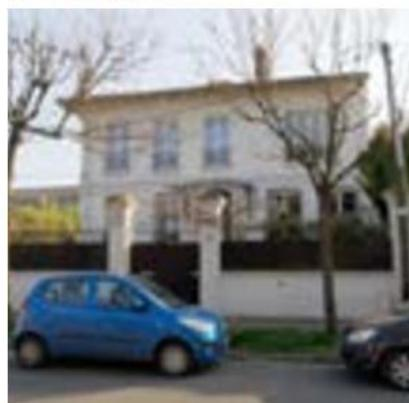
Cette maison de maître est originale car la façade ne présente aucune symétrie : rare ! Plus étonnant encore, le rythme des fenêtres de l'étage ne correspond pas à celui des ouvertures du rez-de-chaussée à droite du bâtiment : la maison a en effet été surélevée en 1909 par l'architecte Alleaume. Notez la frise de briques en dents d'engrenage qui sépare les deux niveaux. La
